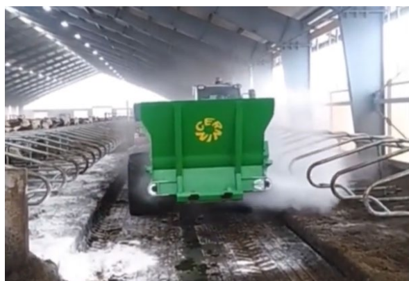
Obr. 4 Dávkování vápence pomocí rychloupínacího míchacího a nastýlacího zařízení L160
