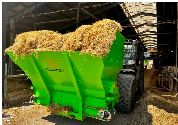
Obr. 1: Rychloupínací nesené míchací a nastýlací zařízení L160 s nastavci naplněné volně loženou slámou
