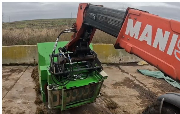
Obr. 2: Nakládání separátu do míchacího zařízení L160 pomocí teleskopického manipulátoru
