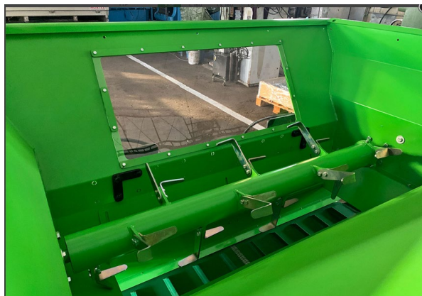
Obr. 5 Čechrač a regulační plechy rychloupínacího míchacího a nastýlacího zařízení L160
