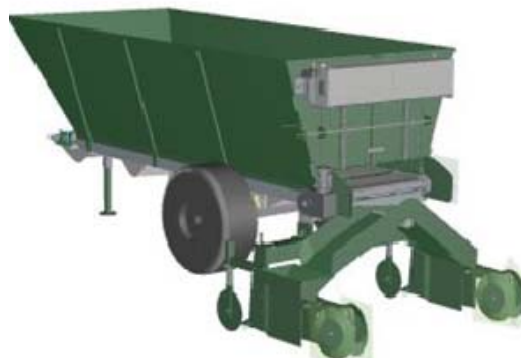
Obr. 1: 3D model zařízení pro hloubkové zapravení organické hmoty do půdy, varianta vinice (Burg, Zemánek)
