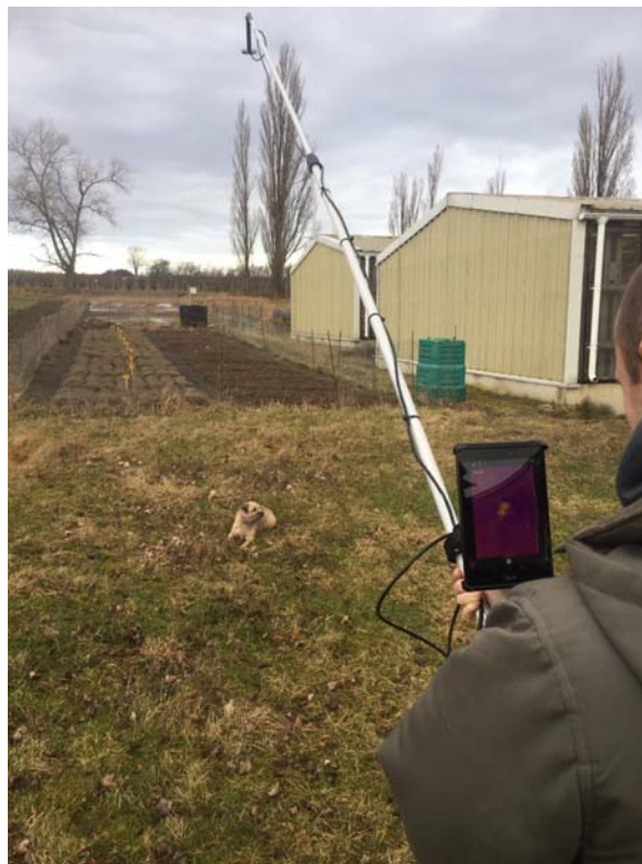
Obr. 2: Vyhledávací zařízení s termografickou kamerou vyrobené ve VÚZT pod označením VMT-VÚZT
