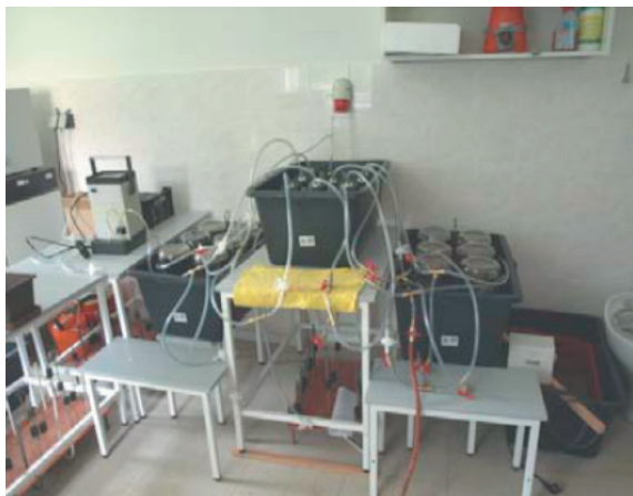
Obr. č. 1: Malé laboratorní fermentory o objemu 1 litr
