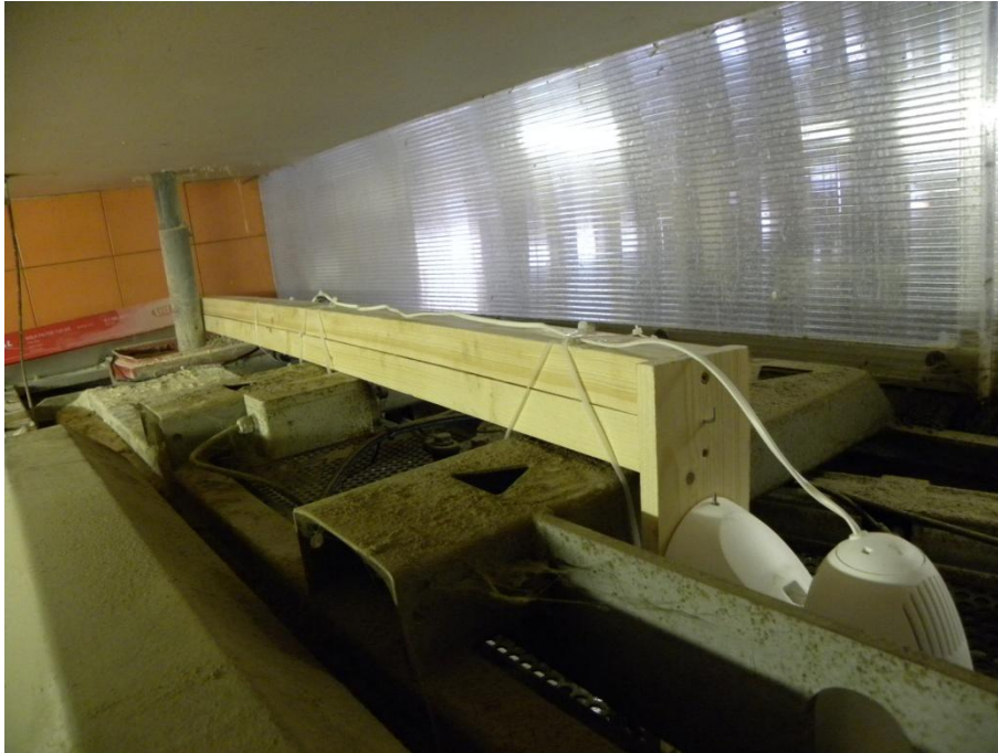
Obr. 1 – Umístění infrazářiče v dojícím robotu Lely Astronaut
