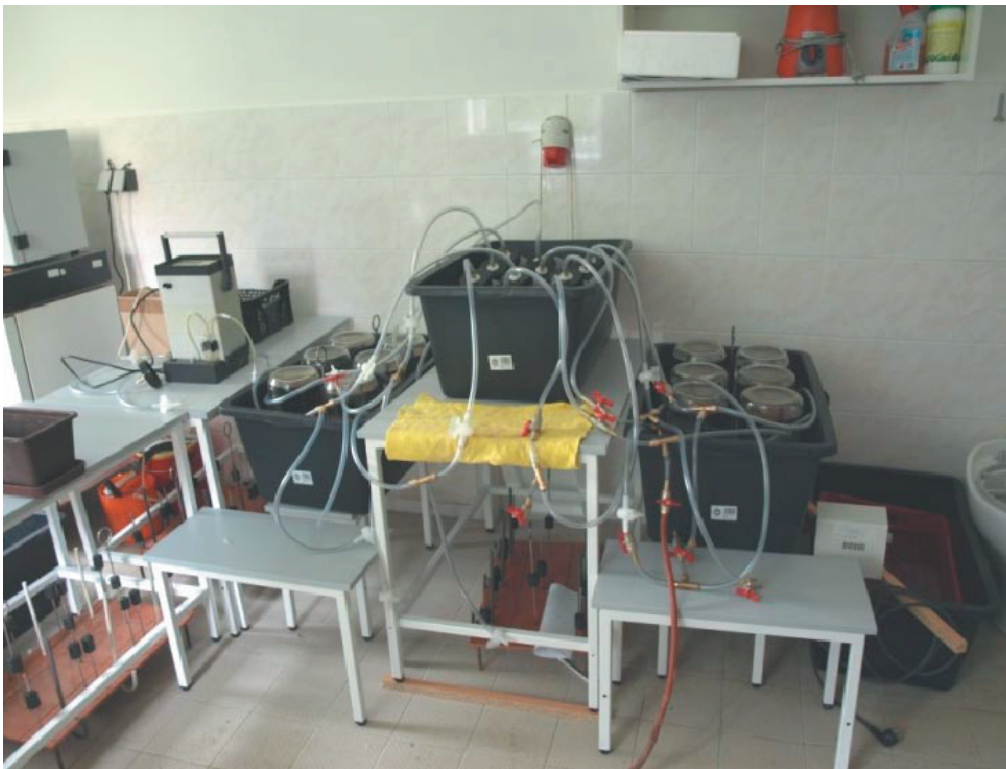
Obr. č. 1: Sada dávkových laboratorních fermentorů ve vyhřívané lázni s plynovej
