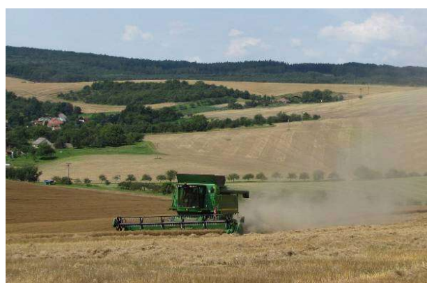
Obr. 4.: Sklizeň olejného lnu odrůdy AMON sklízecí mlátičkou John Deere C670 HillMaster ve zvlněné krajině s nainstalovaným snímačem GPS souřadnic.
